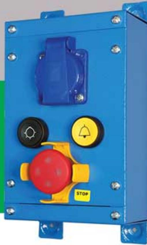
پیت باکس جعبه‌ای است که در چاهک آسانسور به منظور افزایش ایمنی و کنترل پذیری آسانسور، نصب می‌شود. این محصول مشابه جعبه رویزیون، با اندکی تفاوت است. مطابق با استاندارد EN81-20 استفاده از پیت باکس الزامی است.
